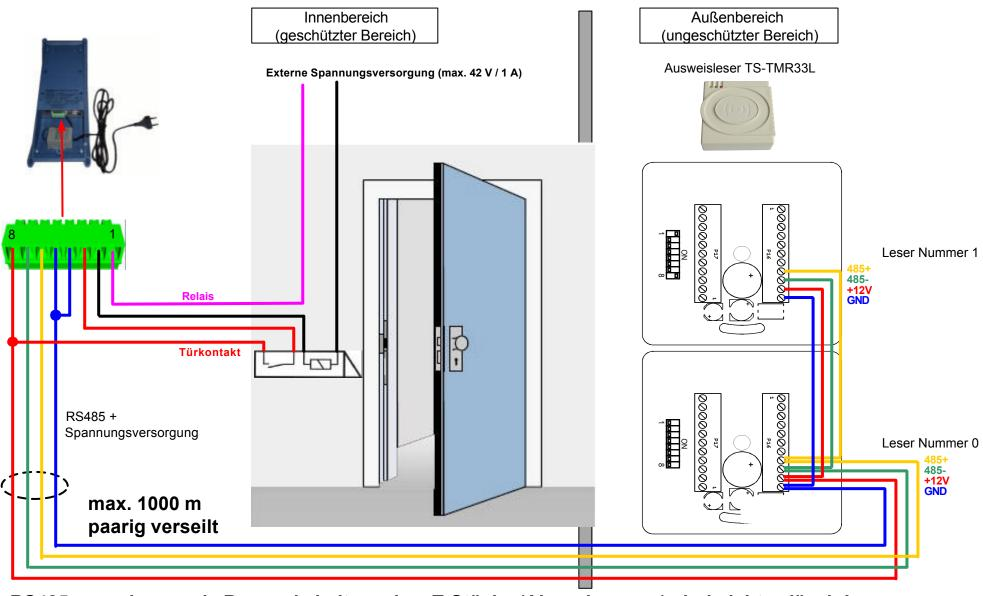
RS485 muss immer als Bus verkabelt werden, T-Stücke (Abzweigungen) sind nicht zulässig! Am letzten Leser am Kabel muss der Schalter 8 auf ON stehen, da dies den Bus abschließt.
